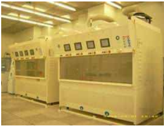
(圖一) Class 100 化學清洗蝕刻工作站。
