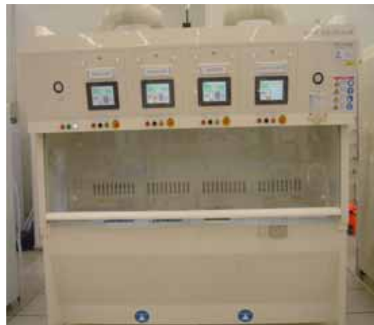
(圖四)爐管前清洗工作台
