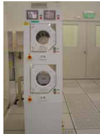
(圖二)晶圓乾燥用旋乾機。
