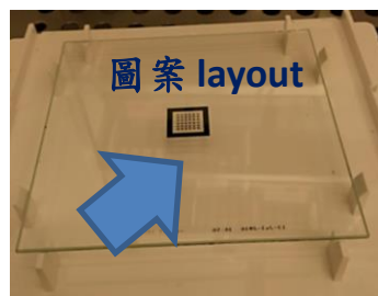
破片線layout只佔光罩一小區域， 可利用多合一光罩設計節省成本
